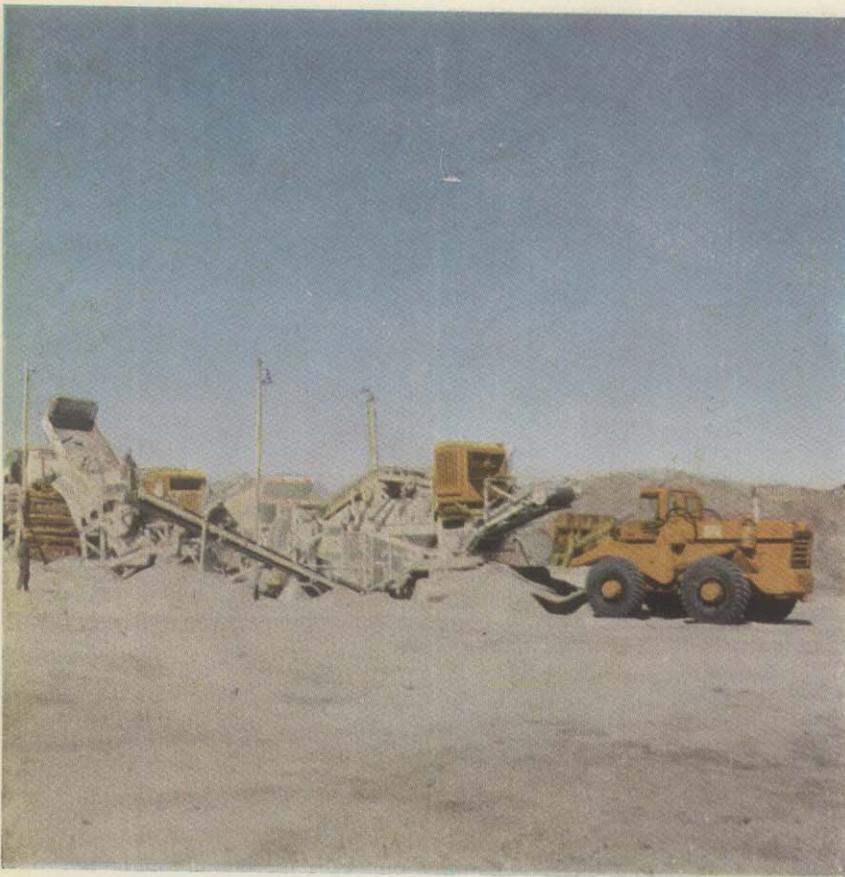
La planta de trituración de la cantera. Al fondo se aprecia el camión volcador que trae, del frente, el material extraído. En primer plano el cargador frontal Trojan que va disponiendo la piedra triturada en grandes pilas.
