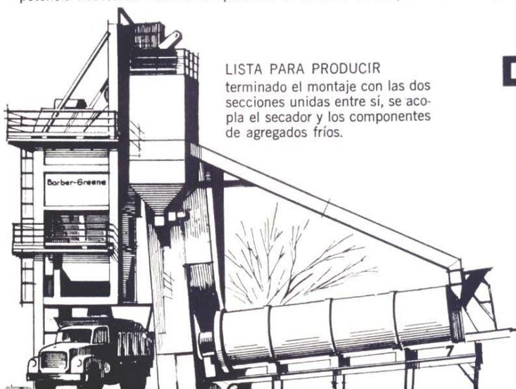
**LISTA PARA PRODUCIR** terminado el montaje con las dos secciones unidas entre si, se acopla el secador y los componentes de agregados fríos.
