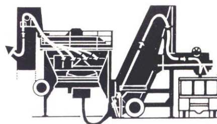
SISTEMA CONTINUO: elevador de agregados calientes, unidad clasificadora y mezcladora
