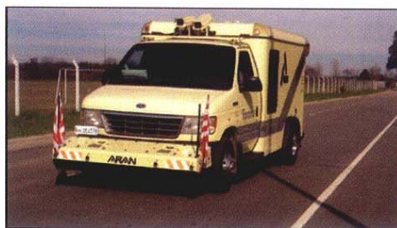
Figura 15. Equipo ARAN (37 sensores ultrasonido)
