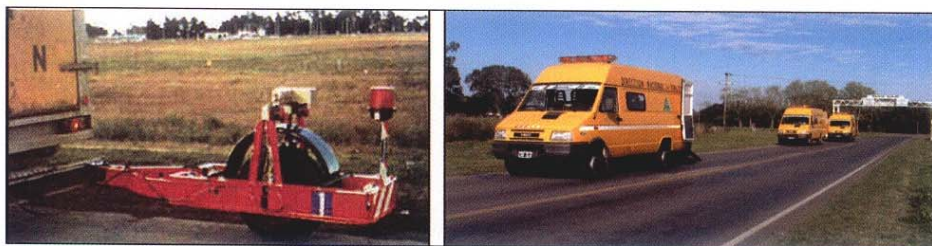
Figura 10. Rugosímetros BPR de la DNV y vehículos de remolque
