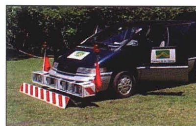
Figura 16. Perfilómetro KJ Law (9 sensores infrarrojo)
