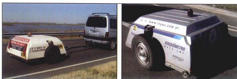
Figura 11. Rugosímetros Mays-JMF de IMAE e ITYAC
