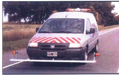
Figura 18. TUS (13 sensores ultrasonido)
