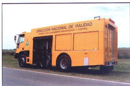
Figura 26. Equipo Scrim Tex, vista general y detalle
