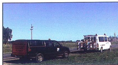
Figura 27. Georadar midiendo con vehículo escolta
