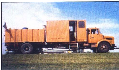
Figura 3. Deflectógrafo Lacroix chasis largo Francés modelo 03
