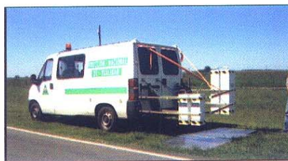
Figura 29. Equipo de la DNV con Antenas posicionadas sobre placa de calibración
