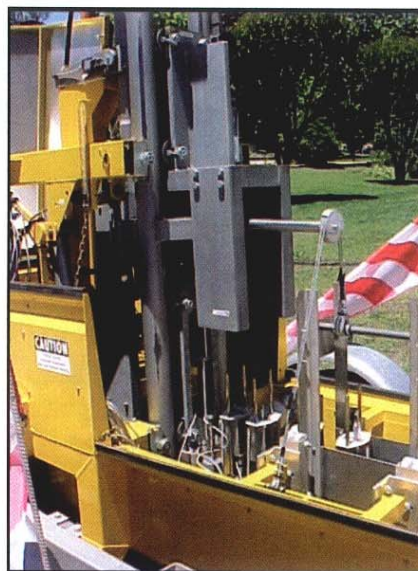
Figura 9. FWD - Kuab Sistema de cargas y sismómetros centrales
