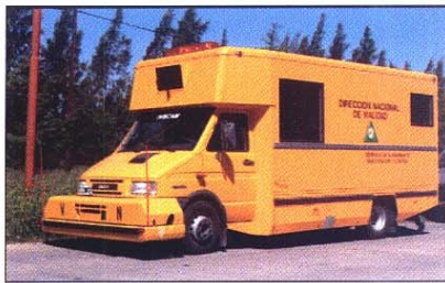
Figura 17. Equipo MRM (16 sensores láser)
