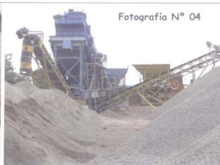
detalle del acopio, de agregado triturado 06 - 12 mm. Se trabajó ingresando los materiales de modo tal que la rotura se produzca preponderantemente entre agregados. Se procuró obtener un buen coeficiente de forma.
