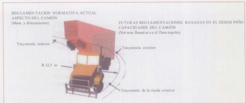
Figura 4: Reglamentaciones normativas vs. basadas en el desempeño para diseños con disposición geométrica
