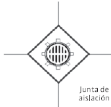
Boca de registro con marco romboidal
