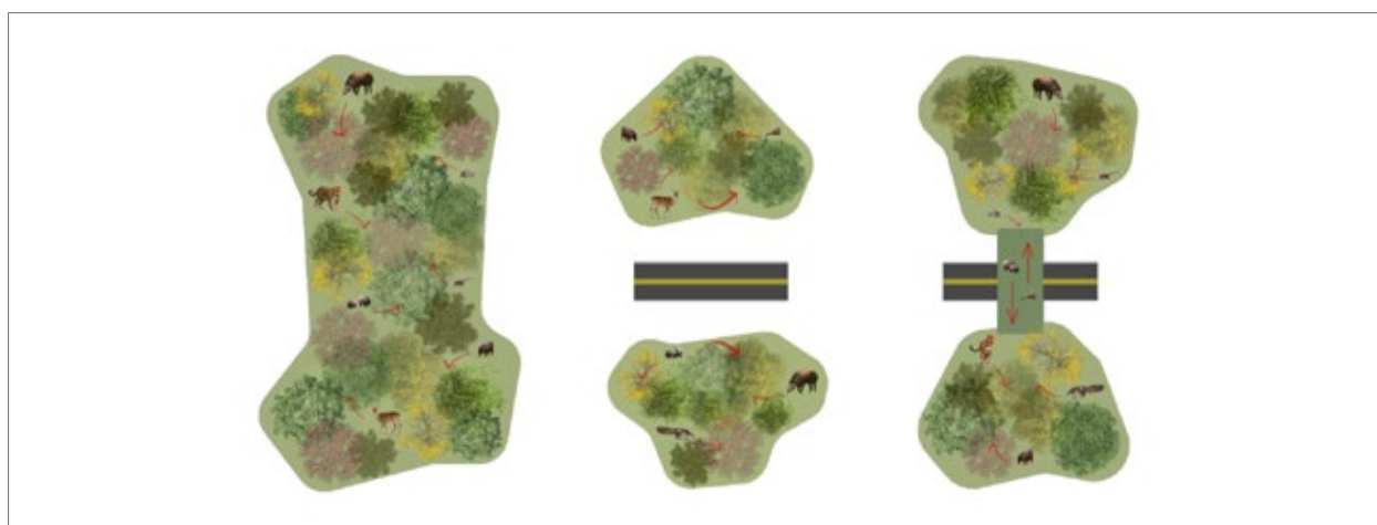
Imagen 15. Representación esquemática de la transformación de un ambiente originalmente continuo en fragmentos más pequeños debido a la construcción de una carretera. La incorporación de pasafaunas (inferiores o superiores) permite reconectar el paisaje fragmentado y separar los desplazamientos de la fauna silvestre del tránsito vehicular.
