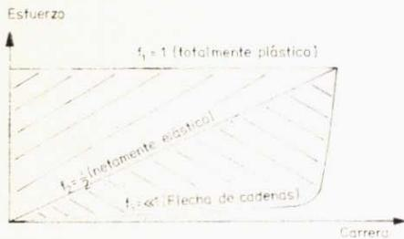
**Ilustración 18:** Posibles diagramas de trabajo para absorber la energía de colisión.
