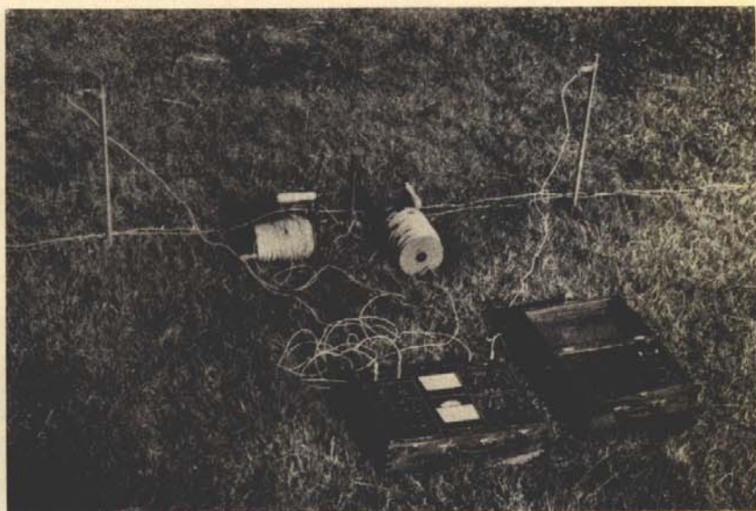
En la fotografía de abajo se muestra el aparato geoelectrico, la fuente de alimentación, el par de electrodos de potencial y carretes en posición de trabajo. Este equipo se utiliza para determinar los distintos estratos o capas de materiales o suelos, así como napas acuíferas, sobre la base del contraste de la resistividad eléctrica.
