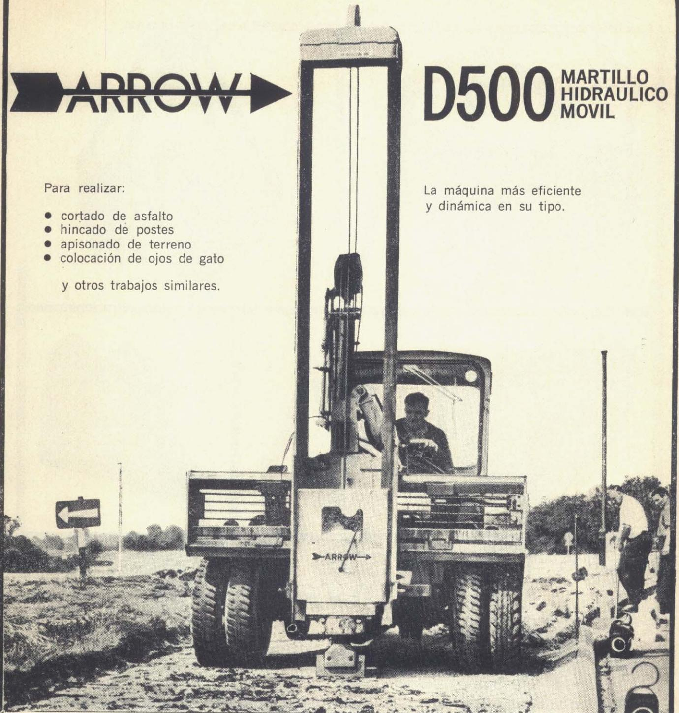
Fabricado por: **ARROW CONSTRUCTION EQUIPMENT LIMITED** Inglaterra
