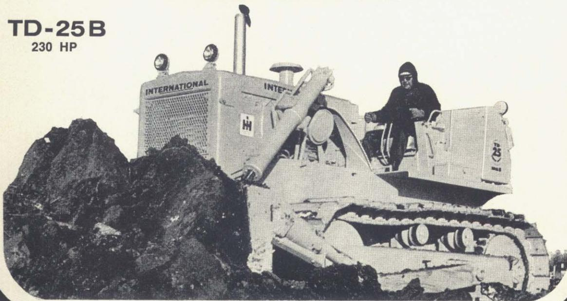
Motores diesel de arranque e inyección directa • Servodirección planetaria en dos etapas
