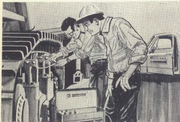
Al poco tiempo de haber iniciado nuestro programa **SEP** ya suman varios centenares las máquinas Caterpillar de carriles cuyo desgaste de rodaje hemos inspeccionado, medido, analizado y registrado.
