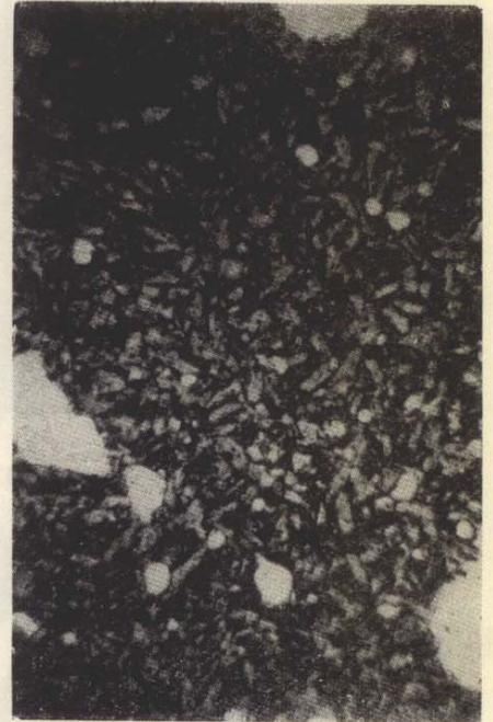
Fig. 1 — Corte petrográfico de la bauxita calcinada a 1.600°C en que se nota el corindón (en negro)
