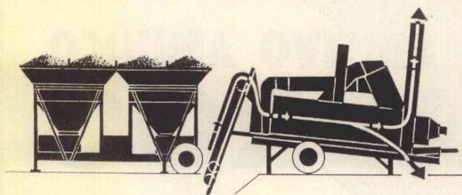
EQUIPO BASE: predosificador, elevador de agregados fríos, secador y colector de polvos
