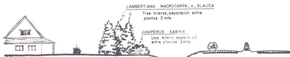
Una barrera vegetal para la atenuación del ruido
