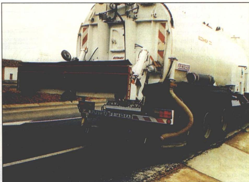
Fig. 1. Sistema de barra con difusores (lineal)
