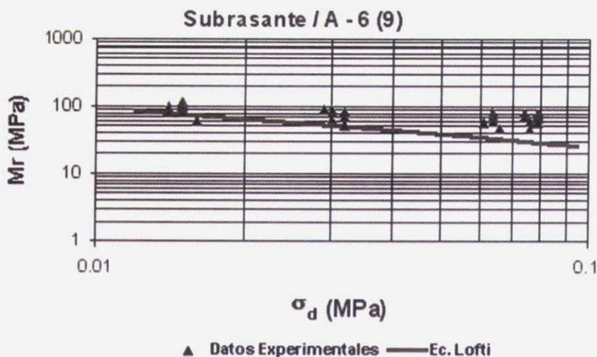
Figura 3 Comparación de los valores experimentales de  $M_r$  para el suelo de Subrasante A 6 (9)
