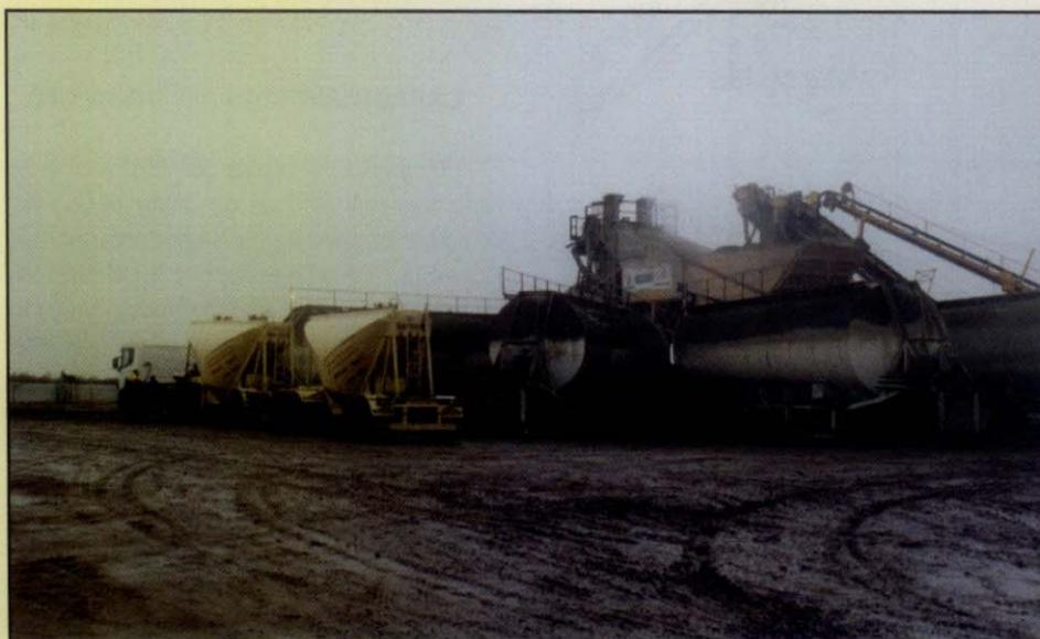
Planta dosificadora y elaboradora de hormigón portátil
