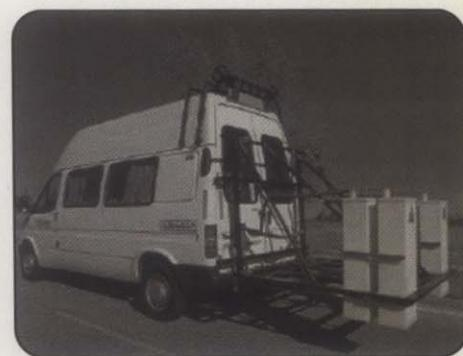
Equipo georrador para medición de espesores de capas de firme
