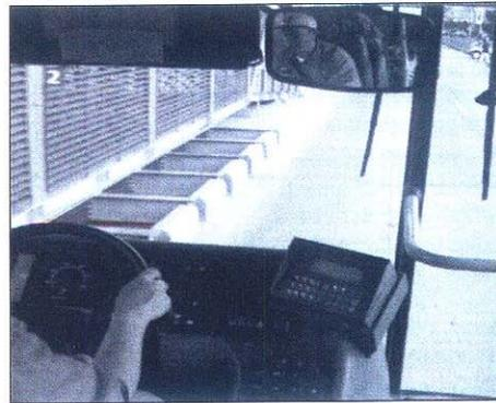
Foto 5. El Computador Inteligente a Bordo (CI-BOR) consigue la información a través de un GPS, odómetro, apertura de puertas y los datos de la consola
