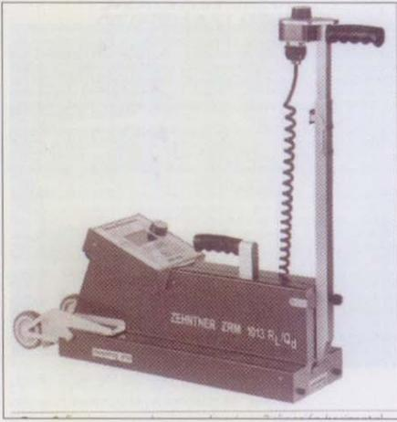
Foto 5. Equipo manual para evaluar la señalización horizontal
