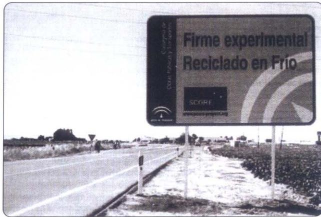
Foto 2 .La obra experimental de reciclado in-situ con emulsión de betún realizada en Moguer(Huelva)
