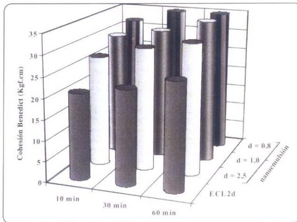
Figura 8. Cohesión Benedict en función del tiempo para varias lechadas bituminosas con una emulsión convencional (ECL2d) y nanoemulsiones de varios diámetros medianos (d en micras) con árido Montorio (0/6)
