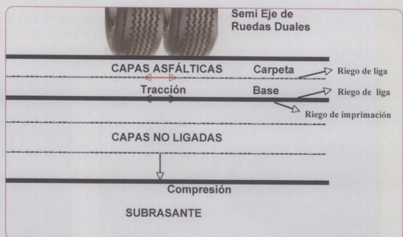
Figura 1. Estructura de pavimento bajo la acción del tránsito
