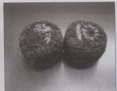
Figura 8. Probetas luego del ensayo Cántabro.
