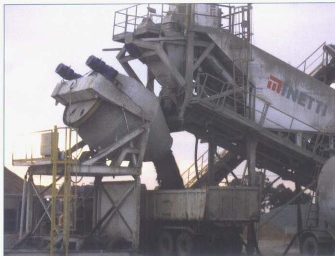
Planta elaboradora de hormigón de 300 m<sup>3</sup> de capacidad de producción horaria, con mezclador de alta energía de 9 m<sup>3</sup>, permite alcanzar las elevadas producciones típicas de las TAR (foto tramo Iecsa)
