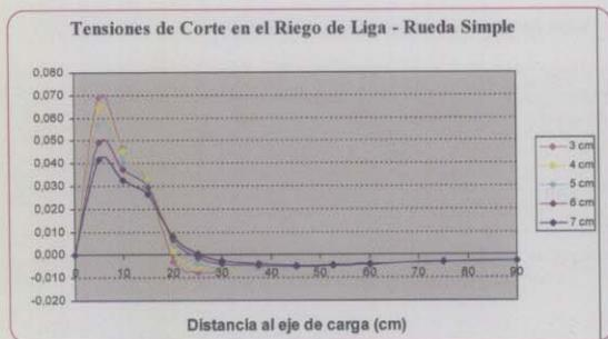
Figura 13. Tensiones de corte sobre el riego para distintos espesores de carpeta
