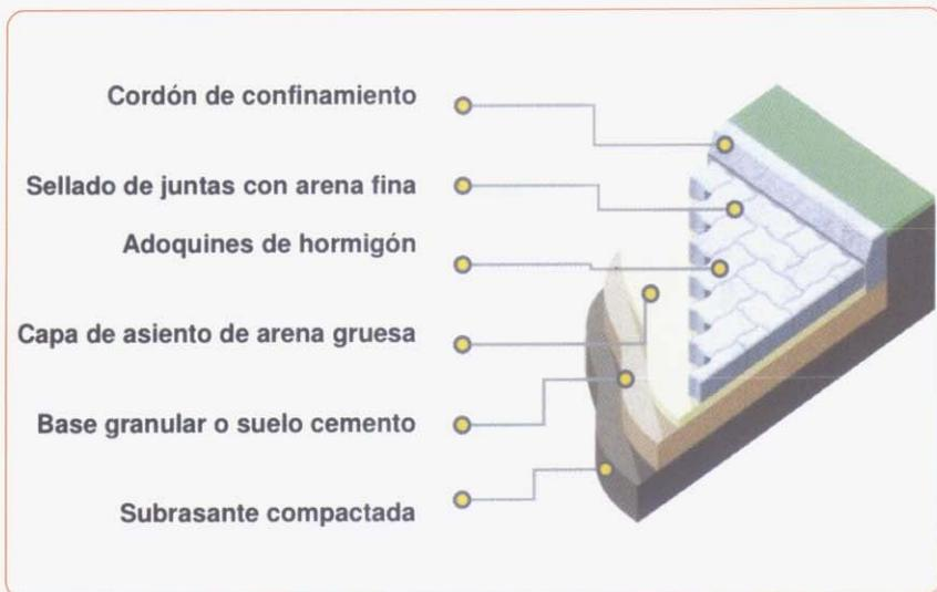
Esquema 1: Paquete estructural típico de un pavimento intertrabado
