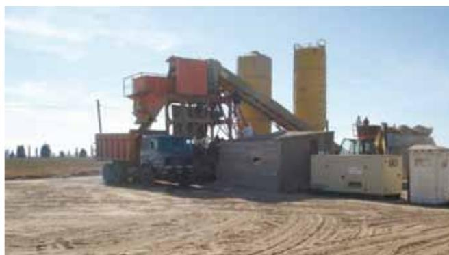
Foto 6: Mezclado en planta central
