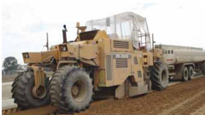
Foto 1: Equipos recicladores – reclamadores en la construcción de bases de suelo cemento
