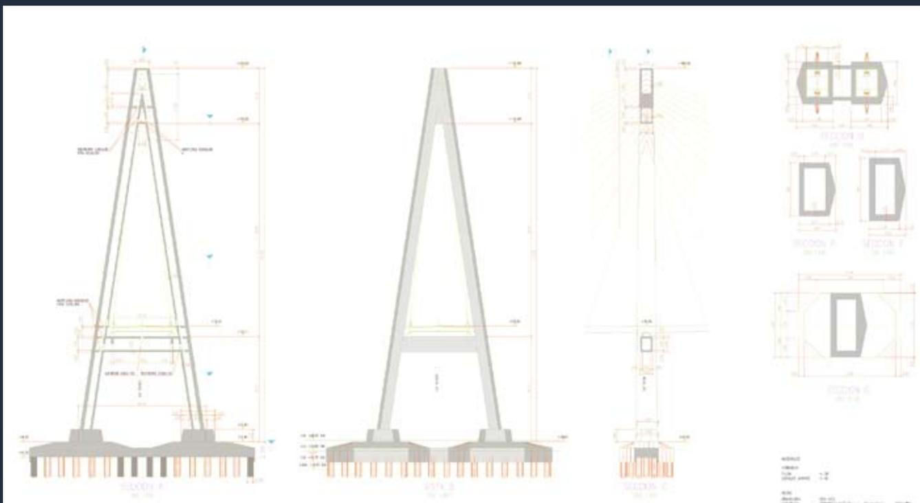
Fig. 8. Pílon y sección transversal de la alternativa mixta.
