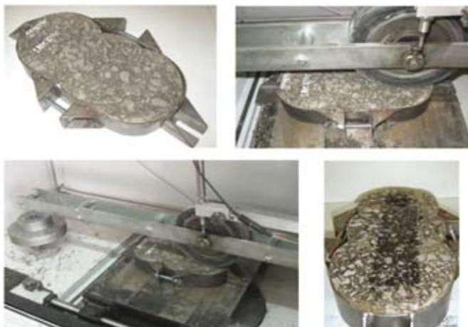
Figura 5: Prototipo del dispositivo de sujeción y ensayo de rueda cargada
