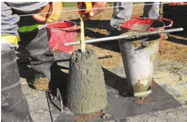
Foto2: Determinación del asentamiento en el frente de trabajo
