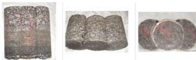
Figura 3: Vistas de probetas caladas
