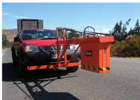
Figura N°3: ANTENA GEORADAR MONTADA EN UN VEHÍCULO Fuente: Dirección de Vialidad, Chile.
