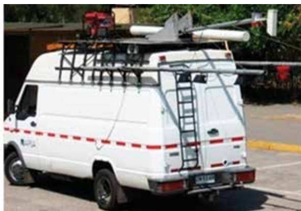
Figura N°2: EQUIPO PAVE INSPECT UNI SURVEY Fuente: Dirección de Vialidad, Chile.
