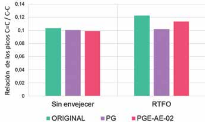
Figura 6. Grado relativo de oxidación de las muestras de asfalto antes y después del envejecimiento
