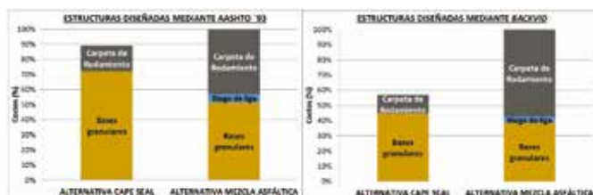
Figura 13. Comparativa económica según estructuras diseñadas con AASHTO '93 y BackVid
